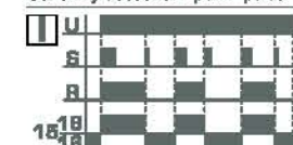
Conexión y desconexión por impulso
